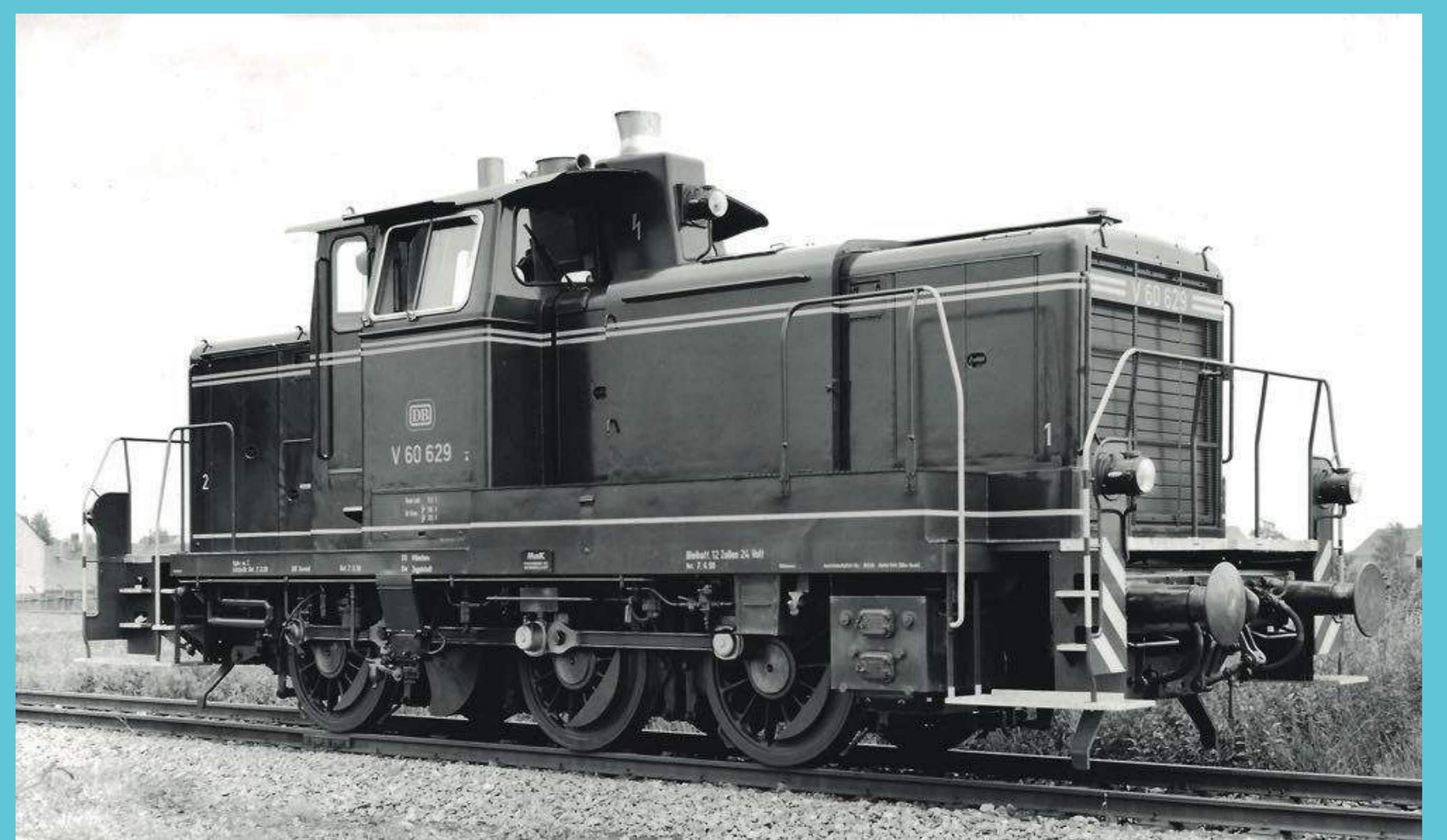
Im Rangierdienst machten sich Dieselloks der Baureihe V 60 nützlich. The Diesel shunting locos of class V 60 were useful for such tasks.
