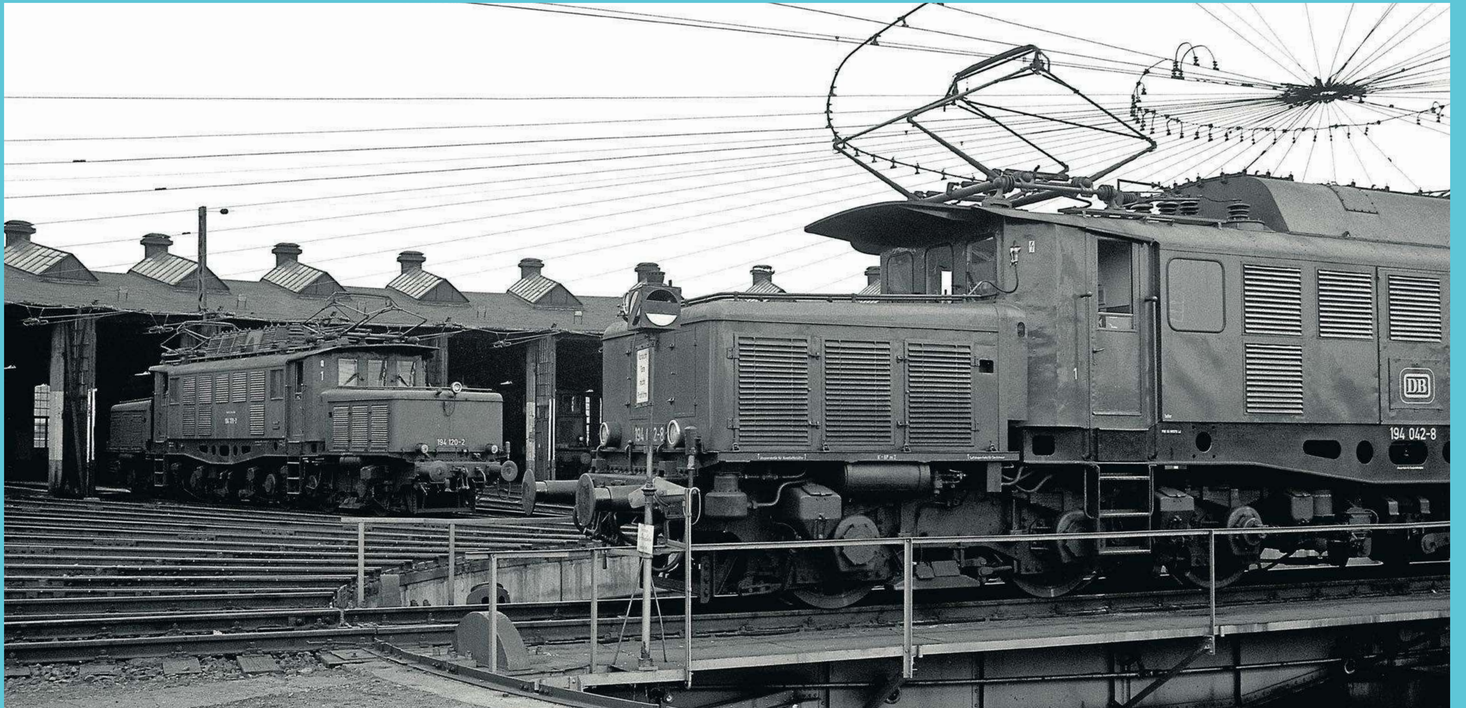
Die Lokomotiven der Baureihe E 94 wurden ab 1940 im schweren Güterzugverkehr eingesetzt. Electric locomotives of the class E 94 were designed 1940 for heavy freight trains.
