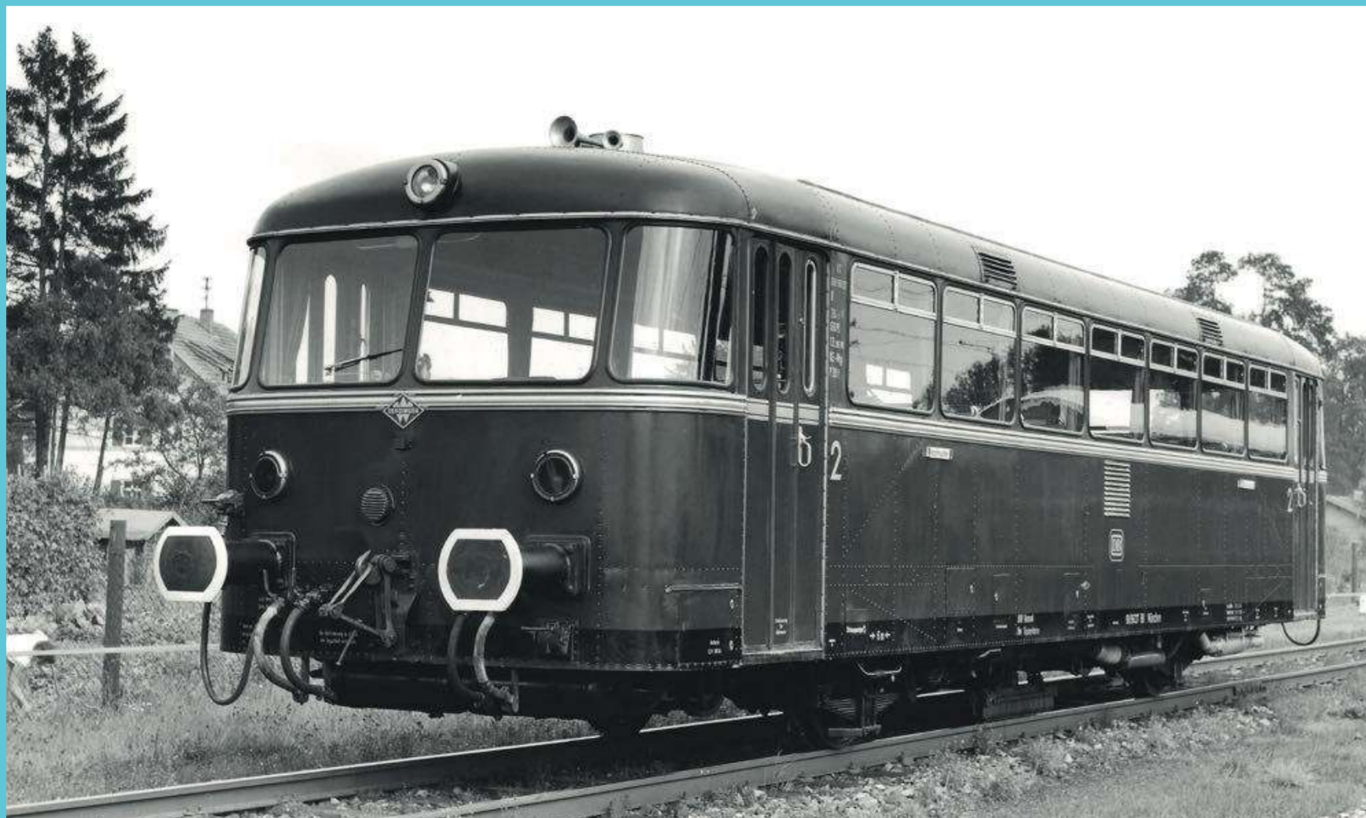
Schienenbusse der Baureihe VT 98 fuhren auf vielen Nebenbahnen. Railbuses of the class VT 98 worked many of the branch lines.
